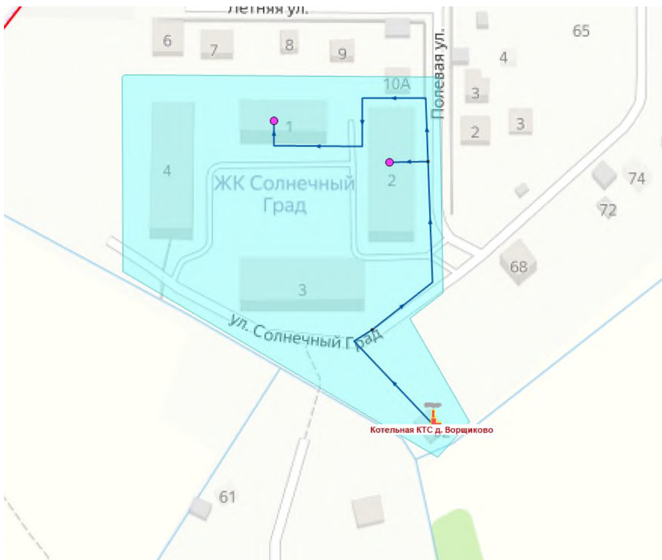
Рисунок 14 – Зона действия источника теплоснабжения ООО «ТЭК-9»
