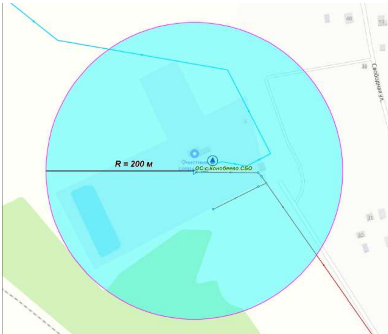
Рисунок 3.1.5.1.1.2. - Схема дислокации очистные сооружения с. Конобеево СБО с размером санитарно-защитной зоны очистных сооружений.
