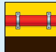
Шланг не должен быть пережат или растянут и должен быть зафиксирован с помощью зажимов безопасности
