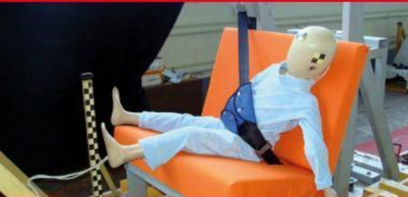
Результаты тестов использования небезопасных удерживающих устройств*
